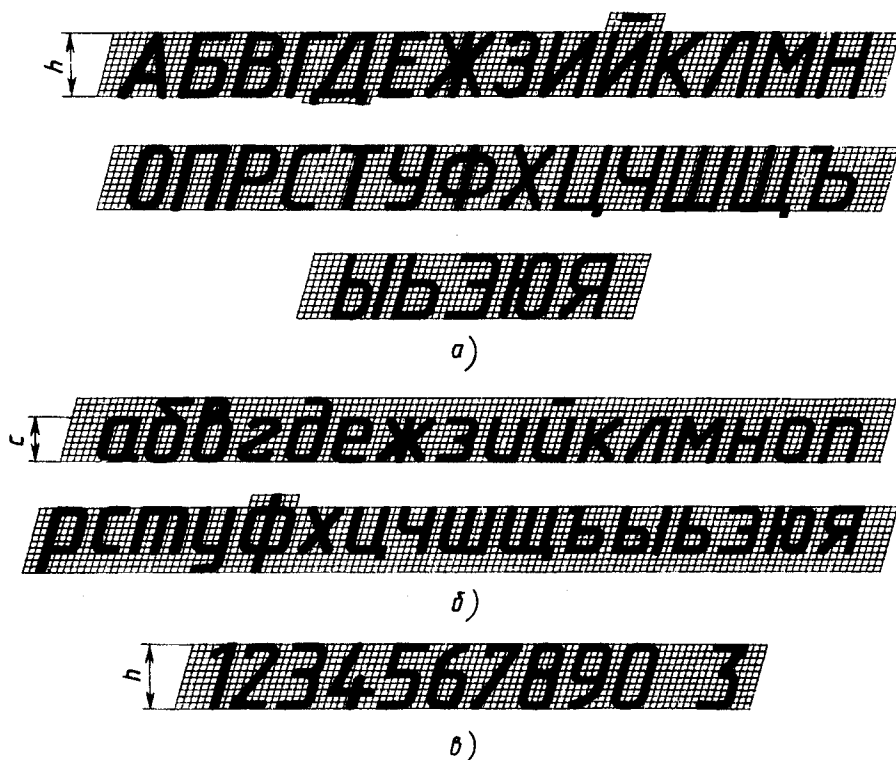
Рис. 7. Чертежный шрифт с наклоном (тип Б): а — прописные буквы, б — строчные буквы, в — арабские цифры
