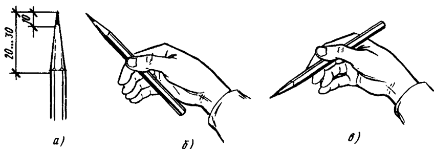
Рис. 249. Заточка карандаша (а) и приемы работы им (б, в)
